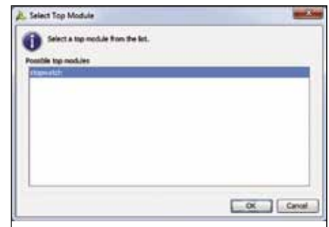
Рис. 21. Выбор модуля описания верхнего уровня иерархии конвертированного проекта
