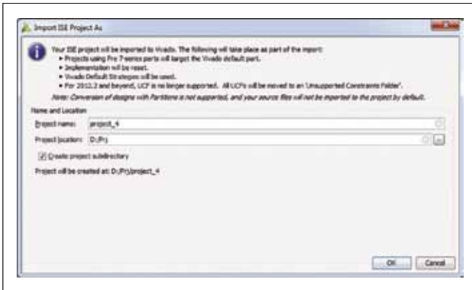
Рис. 16. Запуск процесса автоматического импортирования проекта, созданного в среде Project Navigator
