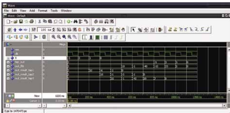
Рис. 10. Окно Wave с результатами моделирования КИХ-фильтра
