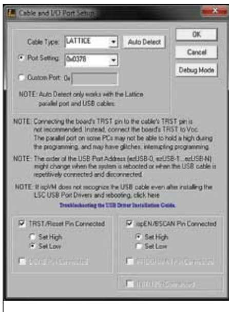
Рис. 8. Окно настройки загрузочного кабеля ispVM System
