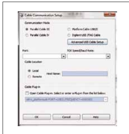
Рис. 26. Окно настройки загрузочного кабеля в iMPACT
