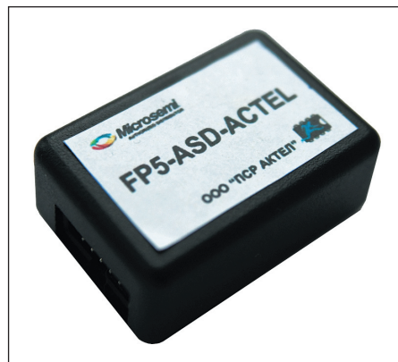
Рис. 2. Программатор FP5-ASD-Actel производства ООО «ПСП Актел»
