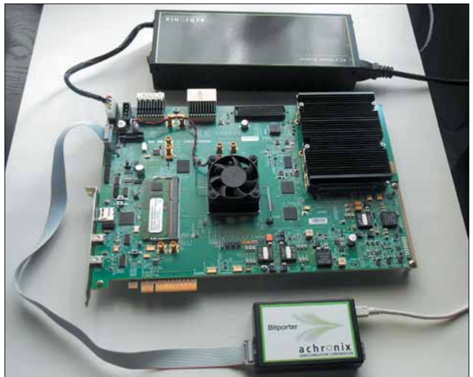
Рис. 14. Подключение «Битпортера» к стартовому набору (слева плоский кабель идет к порту JTAG на целевой системе, а справа USB-кабель направлен к хосту)
