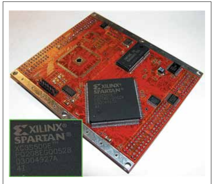
Рис. 3. Плата с инженерным образцом ПЛИС Spartan-3E
